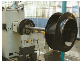
Vyvažování oběžných kol a rotorů
