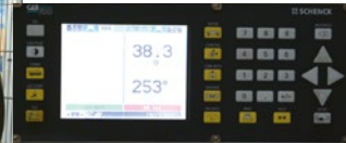
Vyvažování oběžných kol a rotorů
